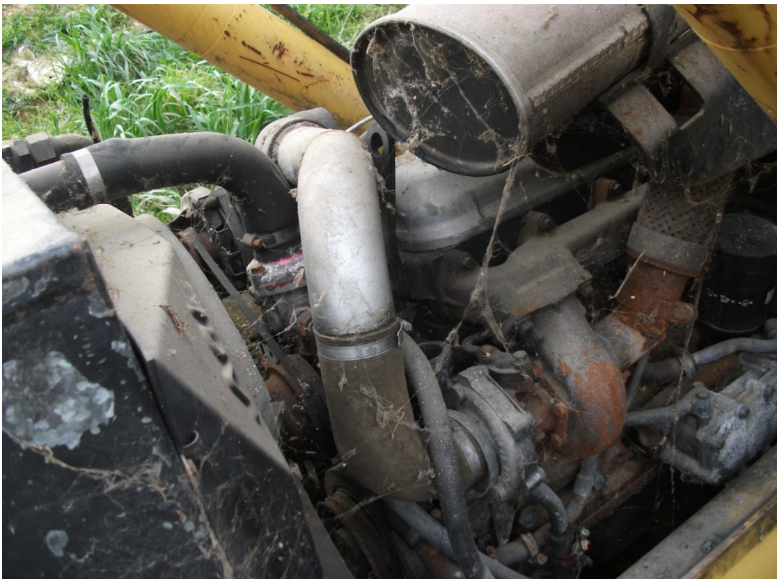
Foto 7 Vano motore completo di turbina e cambio della macchina operatrice
