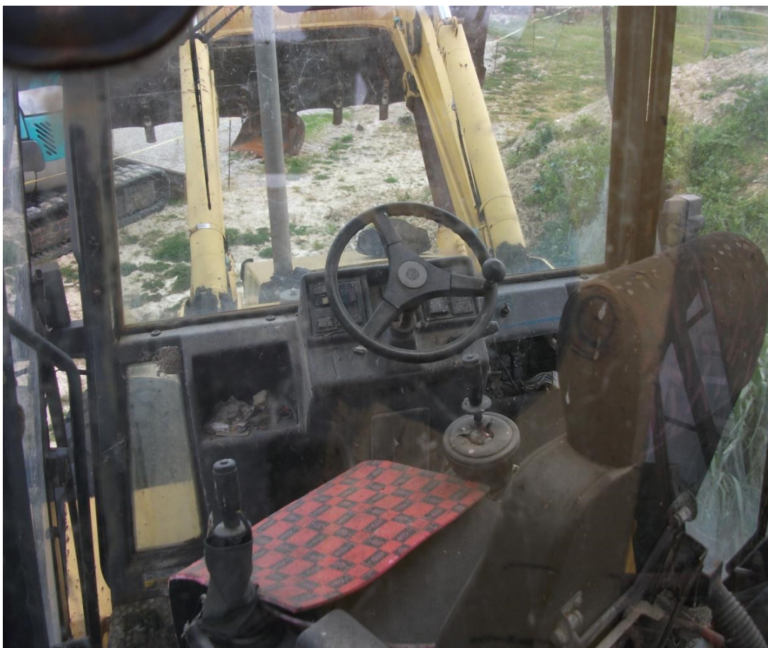
Foto 6 Interno cabina macchina operatrice. Leva cambio rotta
